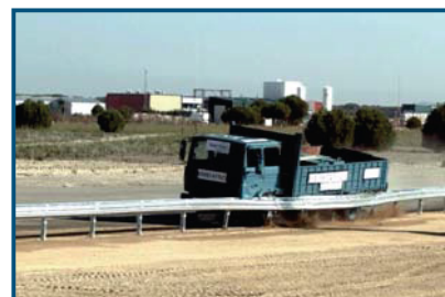
Ensaio TB 42 Caminhão de 10.000 kg, a 70 km/h e 15°
